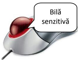
**Trackball** – dispozitiv cu aspectul unui mouse așezat invers, cu o bilă senzitivă în exterior. Deplasarea cursorului pe ecranul de lucru se realizează prin rotirea bilei cu ajutorul degetelor. Trackball-ul poate fi utilizat ca înlocuitor de mouse la calculatoarele portabile și se mai găsește în componența unor tastaturi ergonomice.
